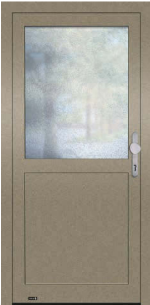
5506-2 Advance 75 Hier mit Glasfalz-Füllung und Stoßgriff 5706 dargestellt. Mit 100 mm Glasleistensprosse Unten wärmegeädmmtes Alu-Sandwich-Paneel, 30 mm stark.
