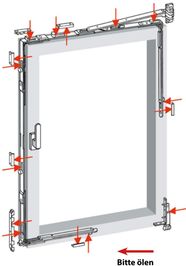
Um die Leichtgängigkeit der Bauelemente dauerhaft zu erhalten, sind die zugänglichen beweglichen Beschlagteile (siehe beispielhafte Skizze) einmal jährlich zu ölen oder mit säurefreien Schmierstoffen zu fetten.
